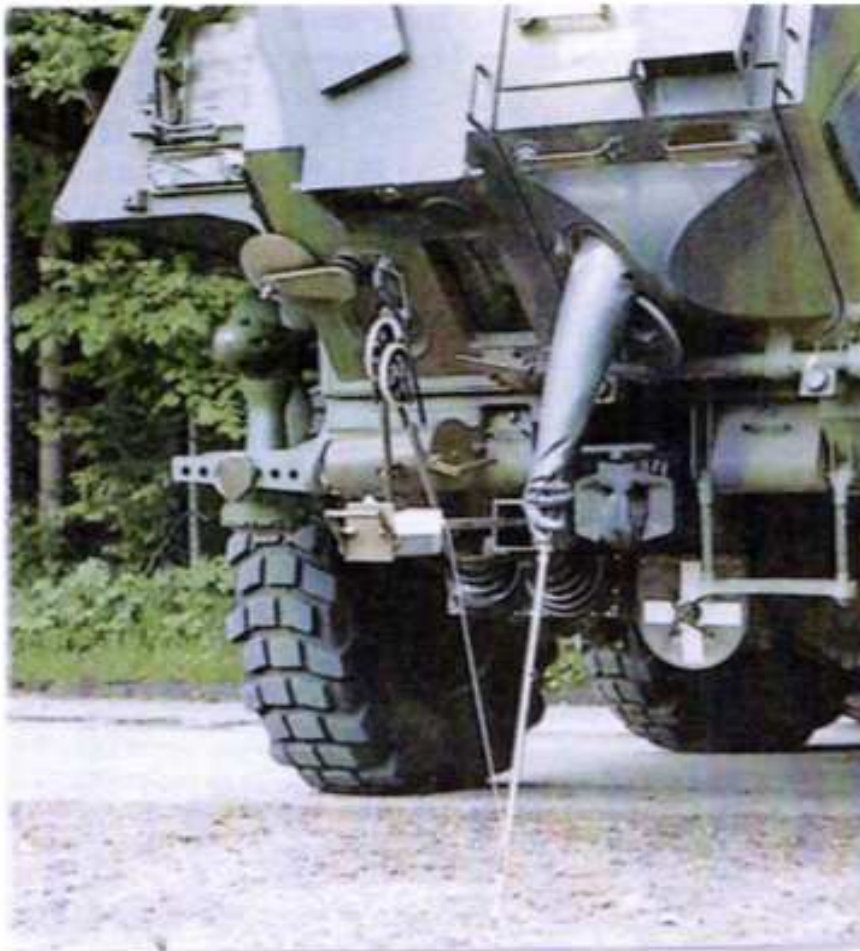
Kampfstoff- spürpanzer im Moment der Probenahme in verseuchtem Gelände. Sehr gut sichtbar ist die ge- schützte Hand des Probennehmers.
